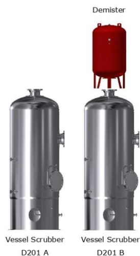
Gambar 6 hasil rancangan perbaikan setelah dilakukan pemasangan vessel scrubber dan demister Sumber: Hasil pengambilan data pemasangan vessel dan demister
