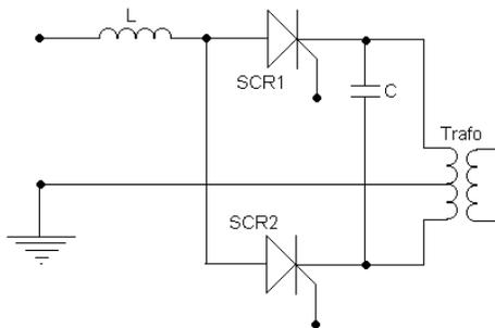
Gambar 4. Rangkaian Inverter
