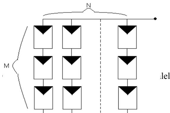
Bila tiap sel surya mempunyai  $I_{out} = I_0$  dan  $V_{out} = V_0$  untuk radiasi maksimum, maka array tersebut mempunyai daya puncak (*watt-peak*) sebesar  $M \times N \times I_0 \times V_0$  watt dengan tegangan  $M \times V_0$  volt. Dan arus sebesar  $N \times I_0$  ampere.
