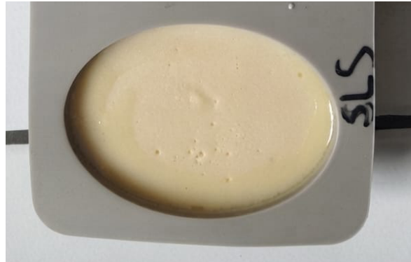
Gambar 3. Dokumentasi sabun batang hasil perbaikan yang berhasil, ditandai adonan menyatu, tercetak, dan mengeras
