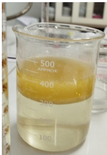
Gambar 1. Dokumentasi hasil uji coba awal pembuatan sabun batang yang gagal karena campuran terpisah menjadi dua fase dan tidak menyatu
