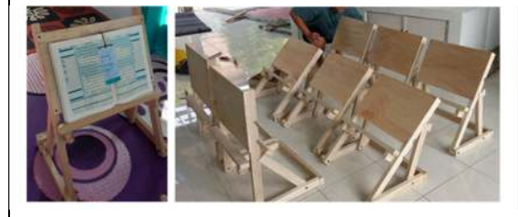
Gambar 2. Prototipe Meja Mengaji Ergonomis Adjustable
