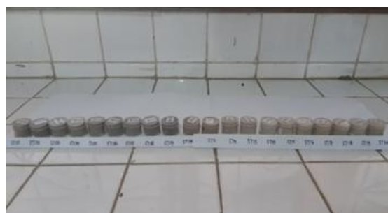
Gambar 6 Sampel untuk uji suseptibilitas magnetik
