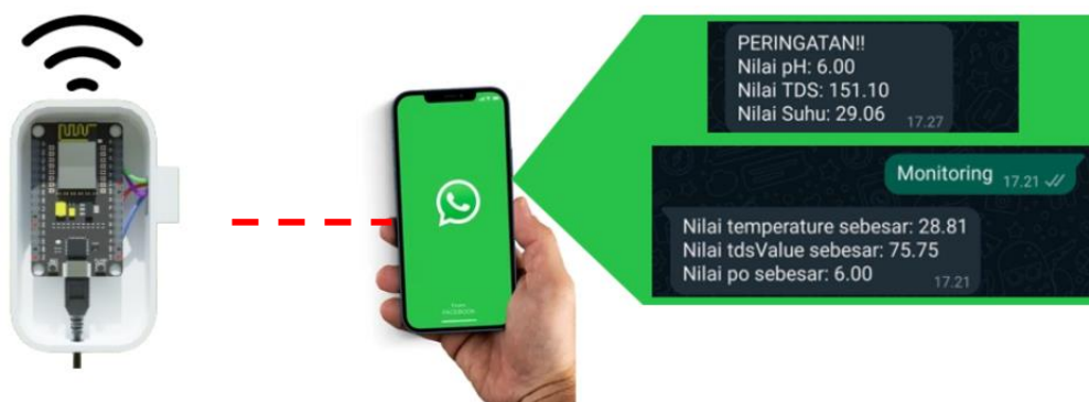
Gambar 7. Sistem Monitoring Kualitas Air melalui Aplikasi WhatsApp
