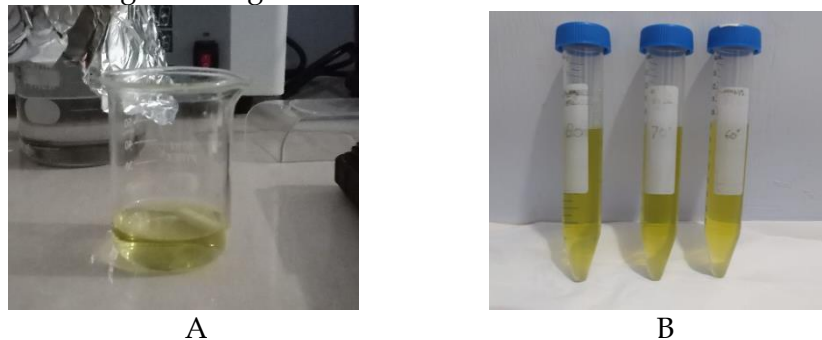
Gambar 2. Warna larutan sebelum dipanaskan (A) warna larutan ketika telah dipanaskan pada suhu 60°C, 70°C, dan 80°C
