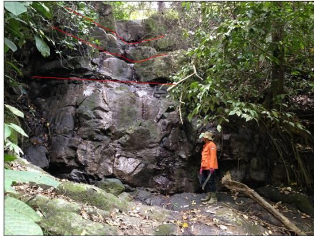
Gambar 7. Singkapan andesit porfiri yang memperlihatkan struktur kekar berlembar (garis merah)
