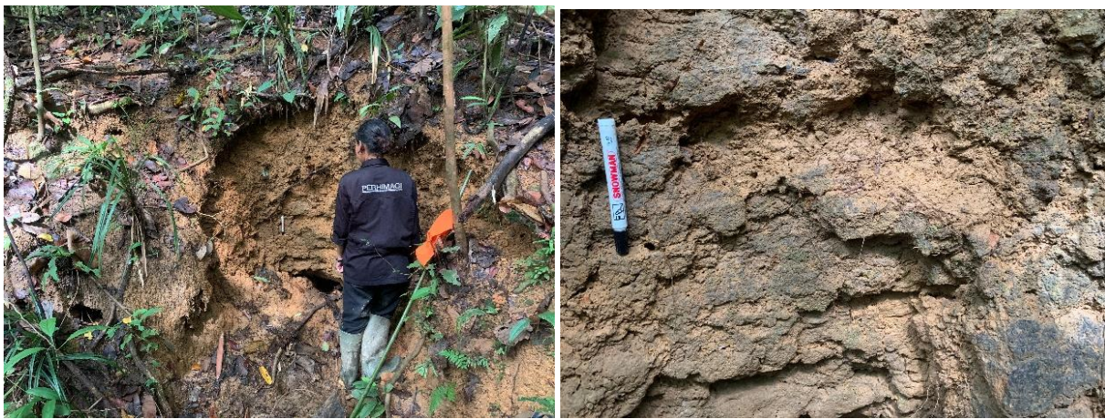
Gambar 4. Singkapan litologi batulempung
