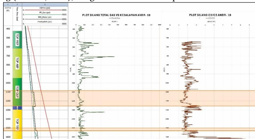
Gambar 10. Plot silang total gas terhadap kedalaman dan rasio C_2/C_3 Sumur ANDR-14 yang memperlihatkan anomali kenaikan total gas disertai penurunan rasio C_2/C_3 pada interval 1.090–1.258 mTVD dan 1.503–1.551 mTVD sebagai indikator pendukung identifikasi puncak zona overpressure mekanisme loading .
