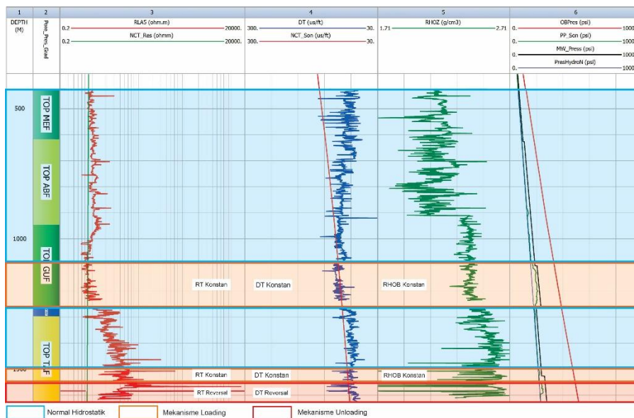
Gambar 9. Profil wireline log dan estimasi tekanan pori Sumur ANDR-19 menunjukkan zona tekanan normal hidrostatik, zona overpressure mekanisme loading ( disequilibrium compaction ) pada interval interval 1.090–1.258 mTVD dan 1.503–1.551 mTVD, serta zona overpressure mekanisme unloading pada interval 1.552–1.594 mTVD yang dicirikan oleh pembalikan tren ( reversal ) log sonik (DT) dan resistivitas (RT).
