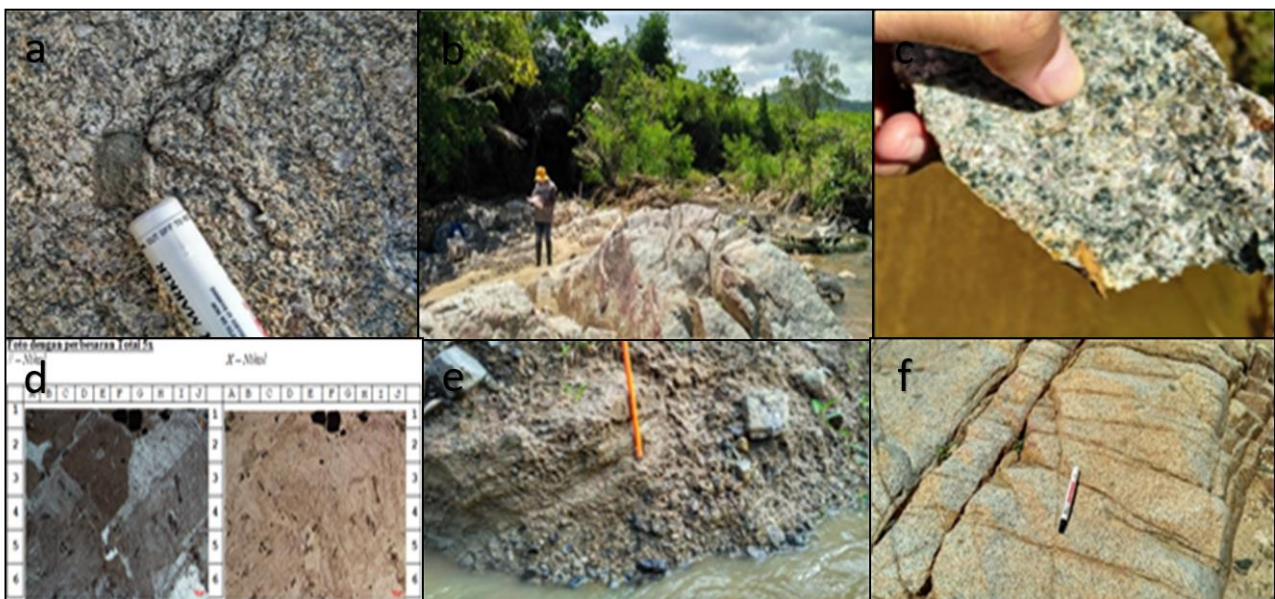
Gambar 6. Kenampakan pada satuan Granodiorit Bualo dan satuan Aluvial Bualo; a) menunjukkan adanya asimilasi xenolith , dimana terdapat xenolith batuan basal di batuan beku granodiorit, b) singkapan batuan granodiorit, c) Contoh hand specimen dari batuan granodiorit, d) Sayatan petrografi dari granodiorit, e) endapan alluvial yang terdiri dari fragmen batuan beku dan material lepas, f) shear joint pada singkapan di Desa Bualo.
