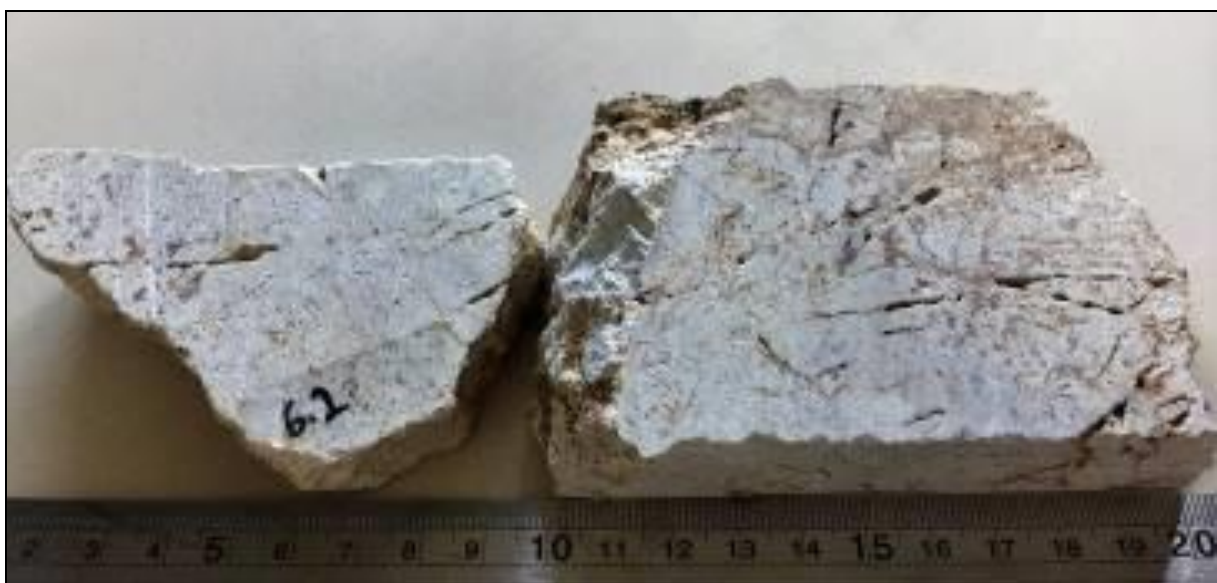
Gambar 11. Sampel hand specimen stockwork memperlihatkan tekstur vuggy fractures yang terisi oleh
