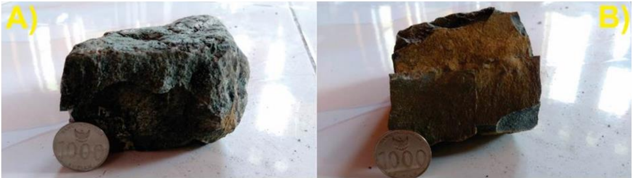
Gambar 11. Hand specimen satuan batupasir perselingan batulanau. A) Batupasir, B) Batulanau pada jalur pengukuran 4 (TS 5.2)
