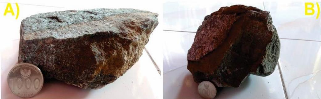
Gambar 3. Hand specimen satuan batupasir perselingan batulanau. A) Batupasir, B) Batulanau pada jalur pengukuran 1 (TS 4.2)
