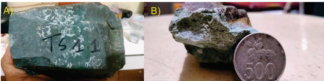
Gambar 8. Hand specimen satuan batulempung perselingan batupasir. A) Batulempung, B) Batupasir pada satuan batulempung perselingan batupasir sisipan lanau jalur pengukuran 3 (TS 2.1)
