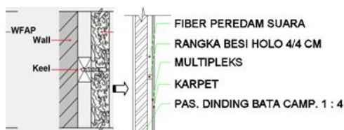
Gambar 18. Dinding yang sengaja disusun untuk mengurangi transmisi gelombang bunyi (Sumber: Akustika bangunan, 2002)
