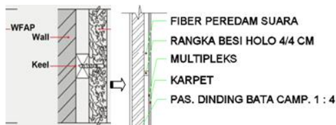
Gambar 18. Dinding yang sengaja disusun untuk mengurangi transmisi gelombang bunyi (Sumber: Akustika bangunan, 2002)
