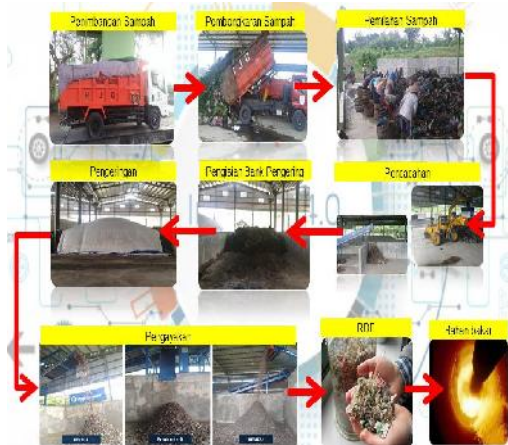
Gambar 13 Alur pengolahan sampah dengan teknologi refuse-derived fuel (Sumber : DLH Cilacap, 2020)
