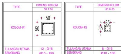
Gambar 23. Detail Kolom
