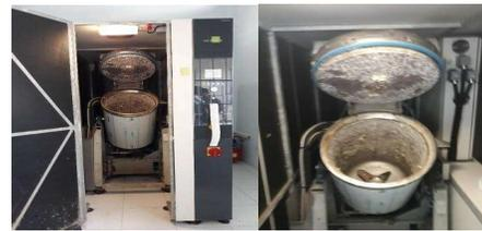
Gambar 18. Alat Pengolahan Limbah Autoclaf
