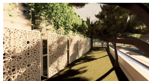
Gambar 6. Penggunaan Secondary Skin pola Islami di sisi timur dan barat (Sumber: Konsep Penulis, 2023)
