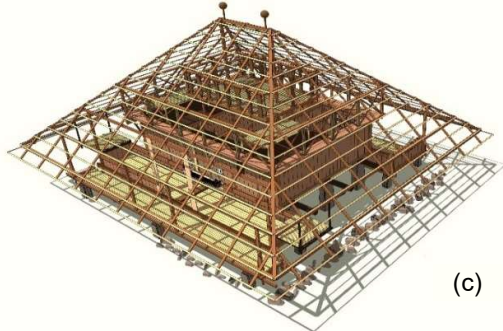
Gambar 13. Struktur Atap Sa'o Ria (a, b, c) (Sumber : Hasil Analisa 3D, 2024)
