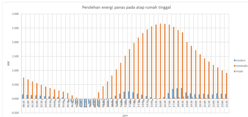
Gambar 11 Perolehan panas melalui atap pada rumah tinggal langgam modern, minimalis, dan tropis
