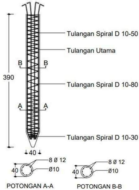
Gambar 12. Detail Pondasi Tiang Pancang & Potongan
