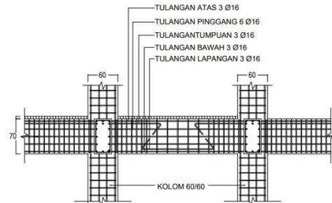
Gambar 14. Detail Sambungan Kolom & Balok
