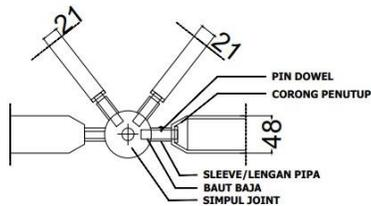
Gambar 21. Detail Sambungan Joint
