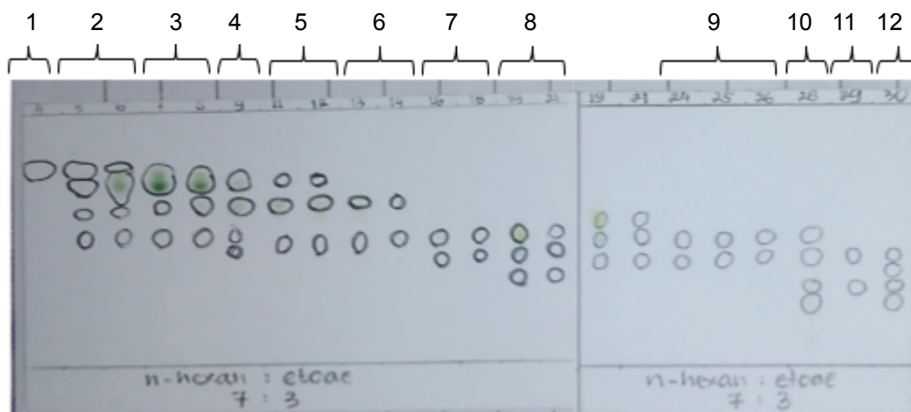
Gambar 2. Profil kromatografi KLT hasil kromatografi kolom gravitasi
