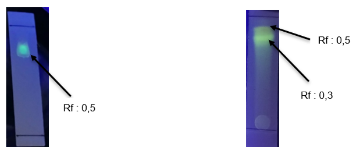
Gambar 1. Profil Kromatografi Lapis Tipis Jahe merah : (a) Eluen Etil Asetat:Aseton (4:2) menggunakan Lampu UV 366 nm, (b) Eluen Kloroform :Etil Asetat : Metanol (3:2:1) menggunakan Lampu UV 254 nm
