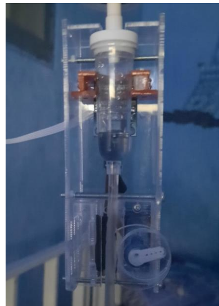
Gambar 9. Hasil Perancangan Sensor Tetes Infus
