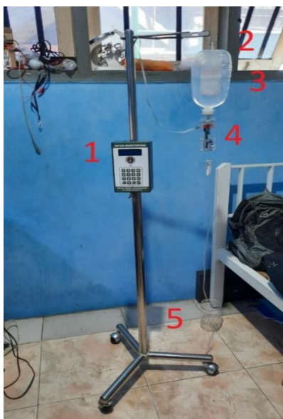
Gambar 8. Hasil Perancangan Perangkat Sistem Monitoring Infus. Keterangan: 1. Kontroler Monitoring Infus, 2. Sensor Berat, 3. Infus, 4. Sensor Tetes Infus dan Motor Servo dan 5. Trolley
