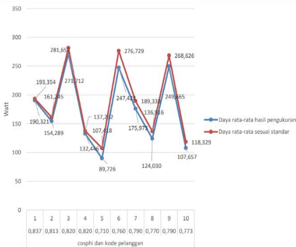
Gambar 5 Grafik pengaruh \text{cos}\phi pada daya 900 VA
