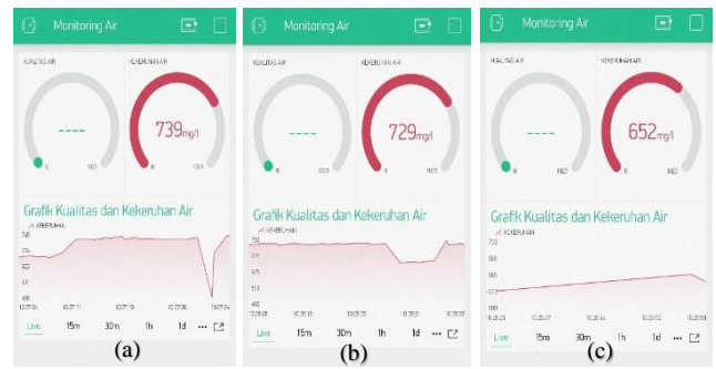
Gambar 7. Tampilan pembacaan sensor SEN0189 menggunakan aplikasi Blynk , (a) Sampel Air Tambak 1, (b) Sampel Air Tambak 2, (c) Sampel Air Sumur
