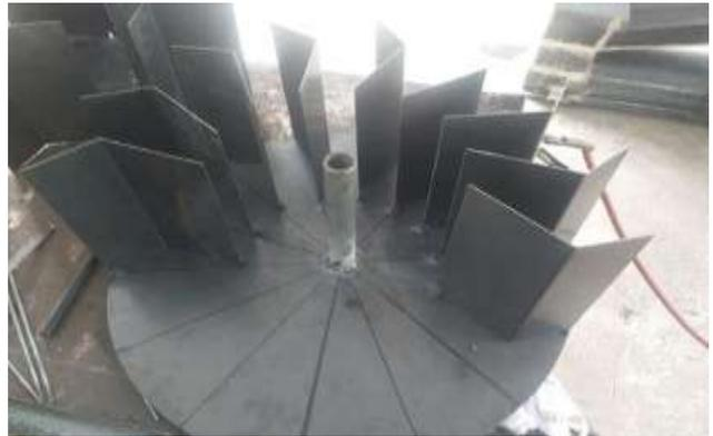
Gambar 5 pembuatan turbin air
