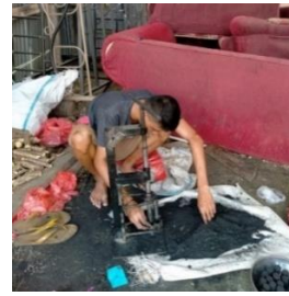
Gambar 8. Proses Pengepresan Biobriket
