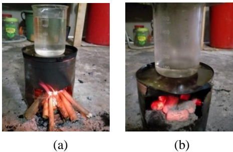
Gambar 11. Pengujian Kalor Dengan Kompor Biomassa (a) kayu (b) biobriket
