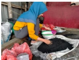
Gambar 7. Proses Pencampuran Arang Dan Tepung Tapioka
