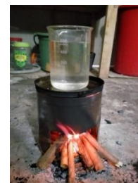
Gambar 2. Pengujian Kalor Dan Laju Pembakaran Dengan Pembakaran Langsung
