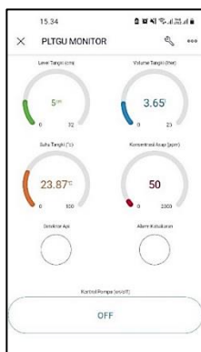
Gambar 26. Pengujian Pengoperasian Pompa dengan Perintah OFF
