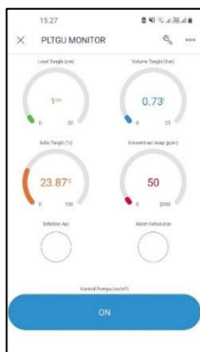
Gambar 25. Pengujian Pengoperasian Pompa dengan Perintah ON
