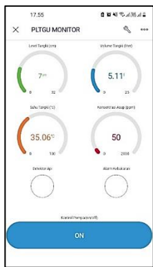
Gambar 18. Hasil Pengukuran Temperatur Pada Aplikasi Blynk
