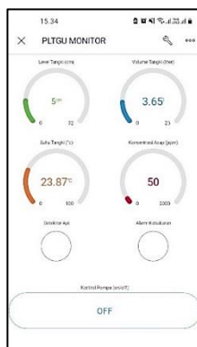
Gambar 26. Pengujian Pengoperasian Pompa dengan Perintah OFF
