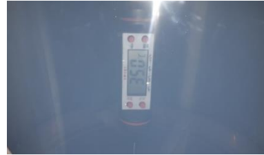
Gambar 20. Hasil Pengukuran Temperatur Pada Alat Ukur Standar
