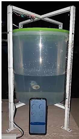
Gambar 17. Hasil Pengukuran Level dan Volume Pada Alat Ukur Standar
