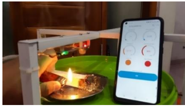
Gambar 24. Hasil Percobaan Saat Ada Api dan Asap
