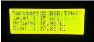
Gambar 16. Hasil Pengukuran Level dan Volume Pada LCD
