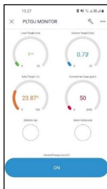
Gambar 25. Pengujian Pengoperasian Pompa dengan Perintah ON
