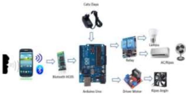
Gambar 1. Blok Diagram Sistem Kontrol Peralatan Listrik
