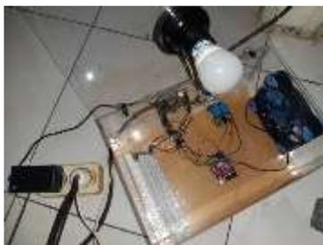
Gambar 5. Prototype Sistem Kontrol Peralatan Listrik
