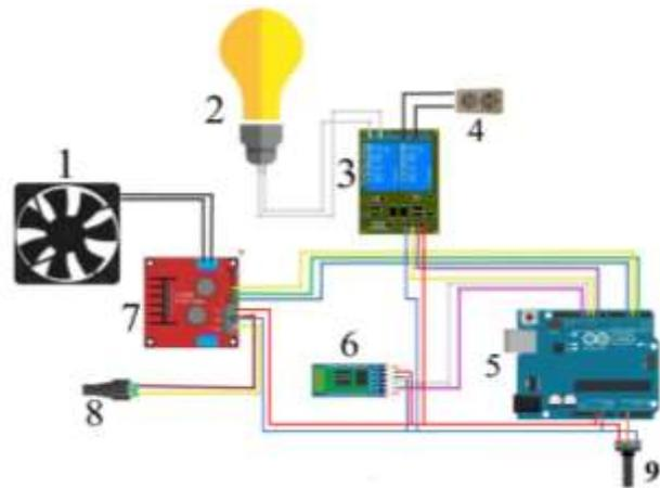
Gambar 3. Rangkaian Perancangan Sistem Kontrol Peralatan Listrik
