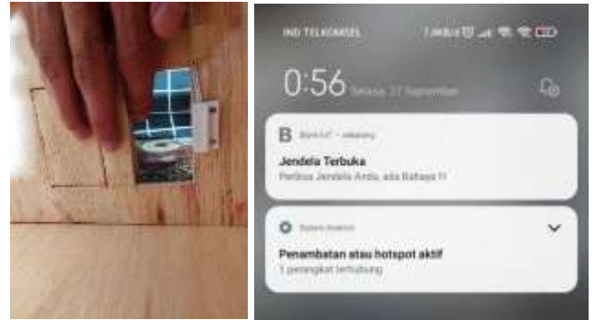
Gambar 6. Notifikasi Jendela Terbuka pada Aplikasi Blynk IoT
