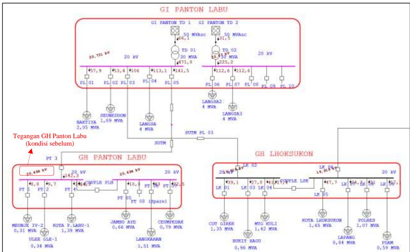
Gambar 1. Konfigurasi Jaringan Sebelum Dilakukan Pembangunan *Express Feeder* SUTM 3x240 mm<sup>2</sup> Sebagai *Incoming* Baru
