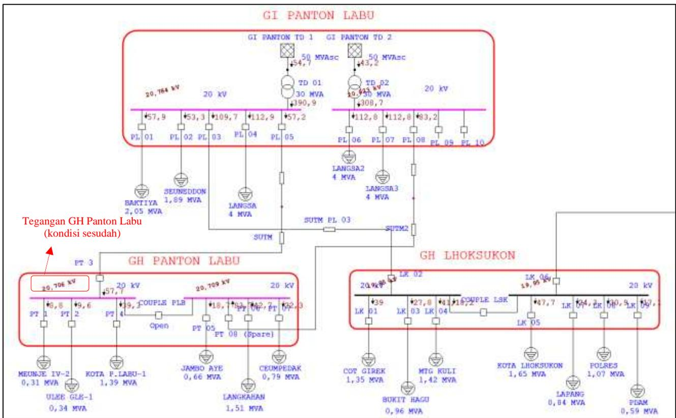
Gambar 2. Konfigurasi Jaringan Sesudah Dilakukan Pembangunan *Express Feeder* SUTM 3x240 mm<sup>2</sup> Sebagai *Incoming* Baru
