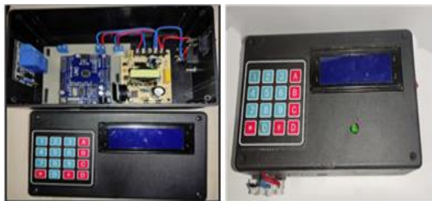
Gambar 5. Rangkaian Utama panel kontrol angin
