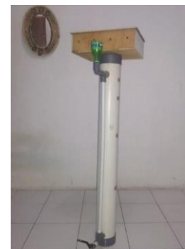
Gambar 7. Bentuk fisik alat peringatan dini bencana banjir
