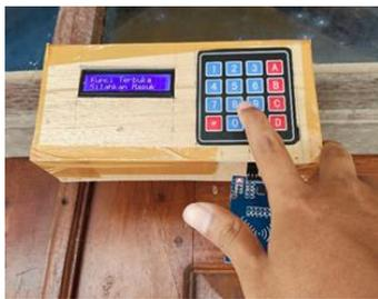
Gambar 17. Pengujian akses menggunakan perangkat keypad
