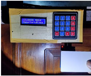
Gambar 13. Pengujian akses menggunakan RFID tag kartu bawaan pada RFID tag reader
