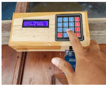
Gambar 17. Pengujian akses menggunakan perangkat keypad
