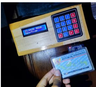
Gambar 15. Pengujian akses menggunakan RFID tag kartu e-KTP pada RFID tag reader
