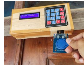
Gambar 11. Pengujian akses menggunakan gantungan kunci pada RFID tag reader
