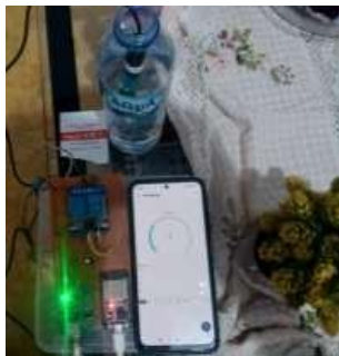
Gambar 8. Pengujian Menggunakan Larutan pH 4
