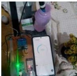
Gambar 9. Pengujian Menggunakan Larutan pH 6.86
