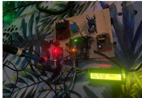
Gambar 9. Pembacaan Sensor pH4502C
