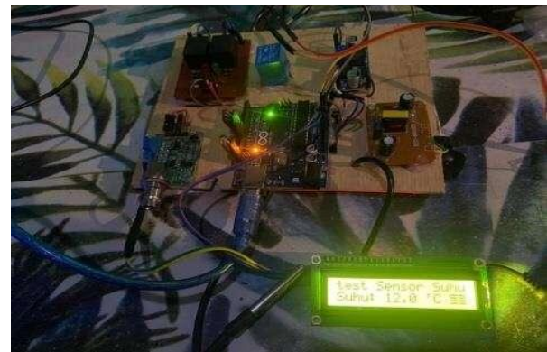
Gambar 10. Pembacaan suhu pada Sensor DS18B20
