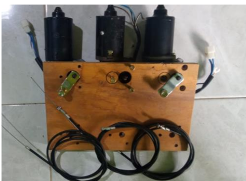
Gambar 7. Pembuatan dudukan motor DC
