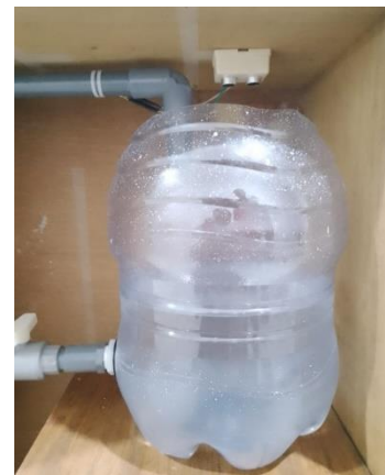
Gambar 10. Pemasangan Sensor Ultrasonik Utama
