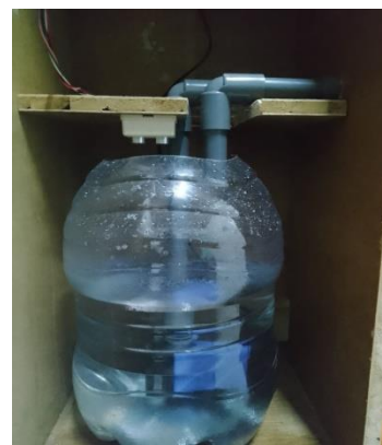
Gambar 11. Pemasangan Sensor Ultrasonik Kedua
