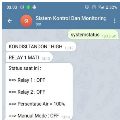
Gambar 22. Pengecekan System status Setelah Kondisi Tandon High
