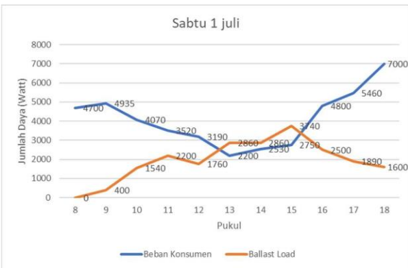
Gambar 2. Grafik daya keluaran PLTMH yang dibagi pada beban rumah tangga dan ballast load
