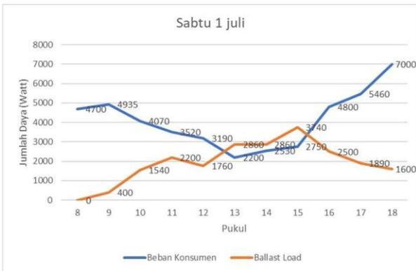
Gambar 2. Grafik daya keluaran PLTMH yang dibagi pada beban rumah tangga dan *ballast load*
