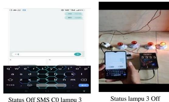
Gambar 16. Pengujian Lampu 3 Off dengan SMS
