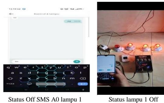
Gambar 14. Pengujian Lampu 1 Off dengan SMS
