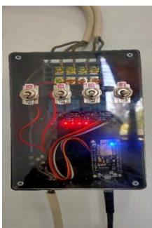
Gambar 19. Pengujian Sistem Kendali Lampu Pada Ruangan Berbasis IoT Arduino Cloud
