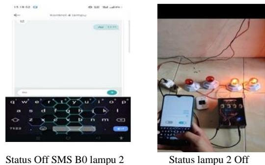
Gambar 15. Pengujian Lampu 2 Off dengan SMS
