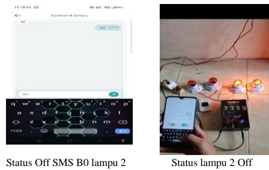
Gambar 15. Pengujian Lampu 2 Off dengan SMS
