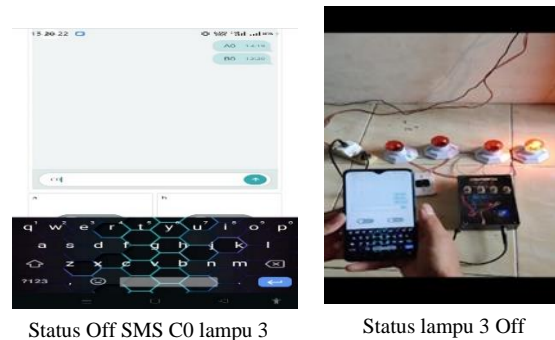
Gambar 16. Pengujian Lampu 3 Off dengan SMS
