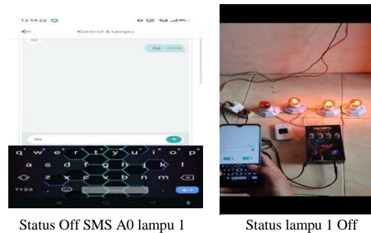
Gambar 14. Pengujian Lampu 1 Off dengan SMS
