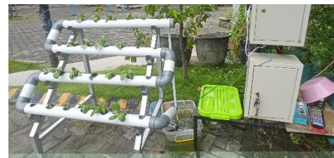
Gambar 3 Alat pengolahan citra Pada Tanaman Pakcoy hidroponik untuk Mendeteksi Kadar Nutrisi AB MIX
