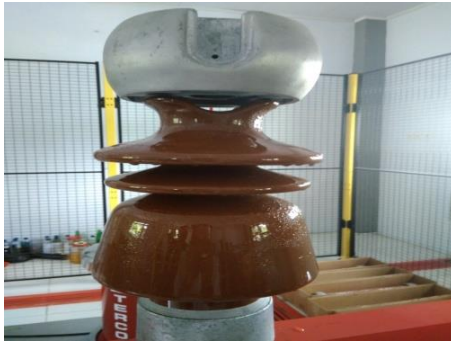
Gambar 3 Pegujian isolator dalam kondisi basah bersih 20 kV tipe pin post
