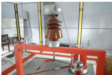
Gambar 2 Pegujian isolator dalam kondisi kering bersih 20 kv tipe pin post
