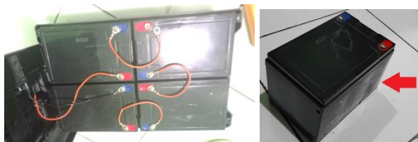
Gambar 2 Kondisi Fisik Baterai Sepeda Listrik dengan pengembungan (ditunjukkan panah merah)
