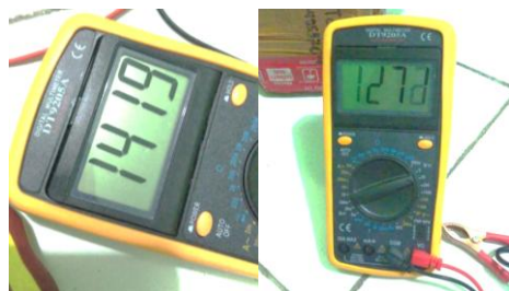
Gambar 3 Pengukuran Tegangan Baterai Menggunakan Voltmeter
