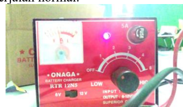
Gambar 4 Battery Charger Eksternal Untuk Mengisi Baterai Secara Paralel
