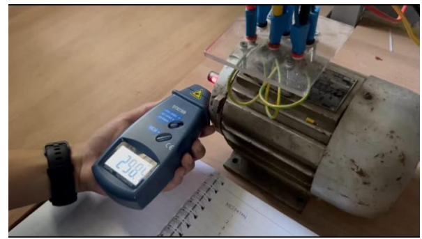
Gambar 15. Pengukuran Kecepatan motor Induksi dengan Tacho Meter
