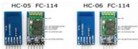
Gambar 2 Module Bluetooth HC-05 & HC-06
