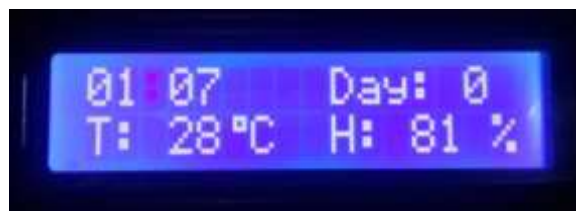
Gambar 6 Tampilan awal LCD dengan notifikasi day
