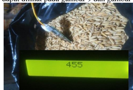
Gambar 9 Pengujian kadar air gabah menggunakan sensor
