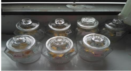
Gambar 2. Desikator Penyimpanan Tujuh Larutan Garam Kimia
