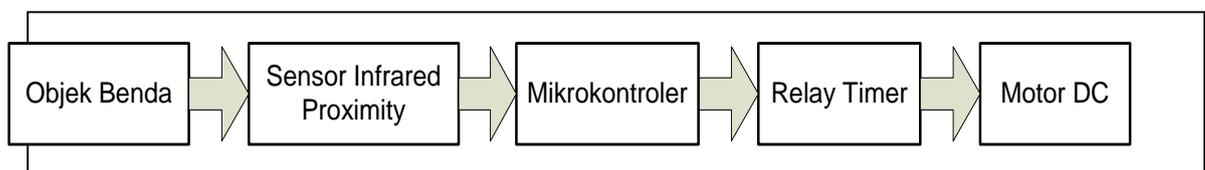
Gambar 2. Blok Diagram Alat Wastafel Cuci Tangan Otomatis
