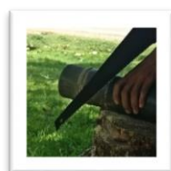
Gambar 33: Memotong bambu menggunakan gergaji (Sumber : Foto peneliti, 2023)
