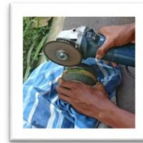
Gambar 34: Memotong permukaan bambu (Sumber : Foto peneliti, 2023)
