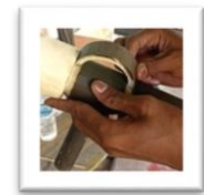
Gambar 15: Proses pemasangan potongan bambu pada sambungan kap lampu (Sumber : Foto peneliti, 2023)
