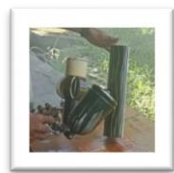
Gambar 19: proses melapisi permukaan bambu dengan cat varnish (Sumber : Foto peneliti, 2023)
