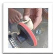
Gambar 27: Menghaluskan potongan bambu (Sumber : Foto peneliti, 2023)
